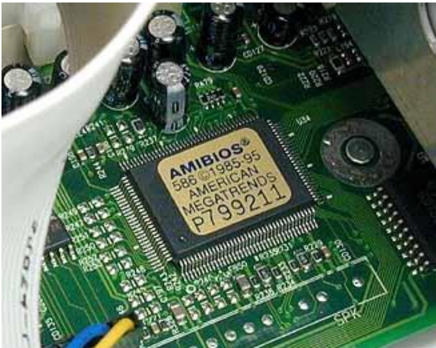
Εικόνα 3 - Το τσιπάκι (κύκλωμα) της ROM που περιέχει το BIOS.
